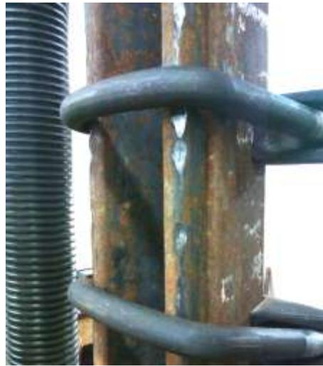
Рисунок 5 – Следы деформации спецпрофиля СВП в местах контакта со скобой замкового соединения перед ее срывом
